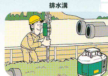
スタッフやデジボーIIと組み合わせれば、排水溝の勾配設定や斜面の比高測定も簡単。
